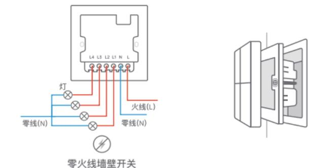
1. 安装之前，确保已切断电源；
