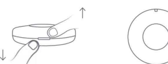
1. 由感应开关侧面的缝隙处抠开上下盖；
